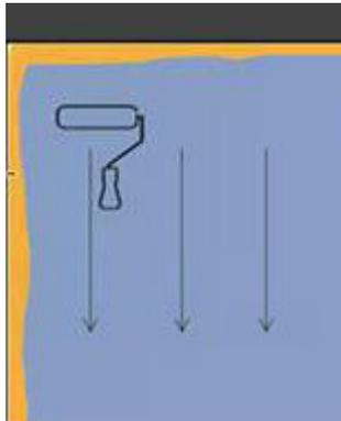
Partielle Ausbesserungsarbeiten in der Fläche nur mit dem gleichen Material und Werkzeug ausführen. Dabei auf gleiche Materialkonsistenz und Charge achten.
