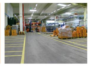
Entscheiden Sie sich für eine Kunststoff-Markierungsfarbe wie z.B. Kronalux® Markierungsfarbe 752. Verwenden Sie keine Straßenmarkierungsfarben in Hallen, diese haben eine zu raue Oberfläche und verschmutzen zu schnell. Greifen Sie bei sehr starker Beanspruchung zu unseren 2K Produkten z.B. Kronalux® 2K-PU-Industriemarkierung 757 oder Kronalux® 2K-PU-Industrie-Markierspray 761. Mit dieser 2K-Hochleistungs-Markierungsfarbe können Sie auch Stahl, Aluminium und verzinkte Flächen
