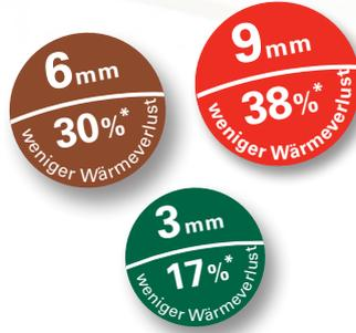
Durch die besonderen Materialeigenschaften ergeben sich attraktive Reduktionen des Wärmeverlustes (im Verhältnis zu einem ungedämmten 24 cm starken Ziegelmauerwerk).
