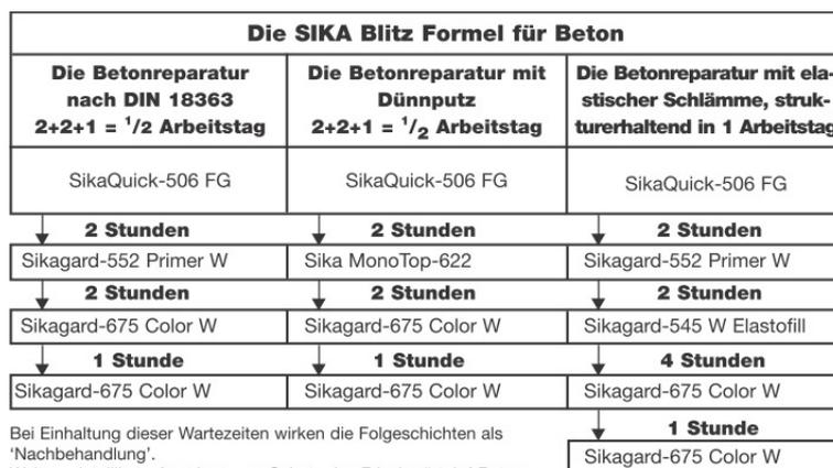
Selbstverständlich kann auch im Rahmen einer üblichen Betoninstandsetzungsmaßnahme mit längeren Wartezeiten – wie nachfolgend dargestellt – gearbeitet werden.
