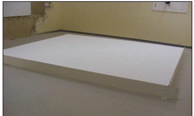
Abb. 5 Prüfaufbau aus 30 Deckenplatten, Sichtseite nach oben, umlaufender Holzrahmen
