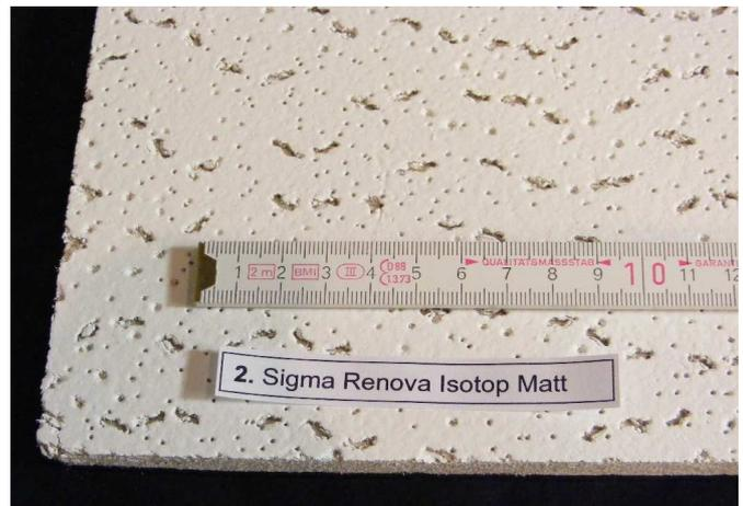
Abb. 2 Sichtseite, zum Hallraum weisend der Deckenplatte, nach 1. Renovierung,
