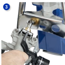
Lösen der Pumpe und Entnehmen der Patrone mittels Sechskant-Rahmenfitting
