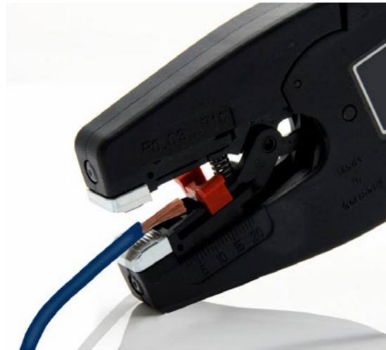
**1** Kabelende mit einer Abisolierzange ca. 10mm abisolieren.
