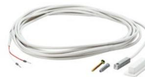
Der Oberflächentemperaturfühler wird auf der endbeschichteten Oberfläche installiert. Hierzu den Fühler mit Schraube und Dübel befestigen. Der Fühler muss an der kältesten Stelle **AUF** der eingespachtelten und endbeschichteten Heizbahn angebracht werden.
