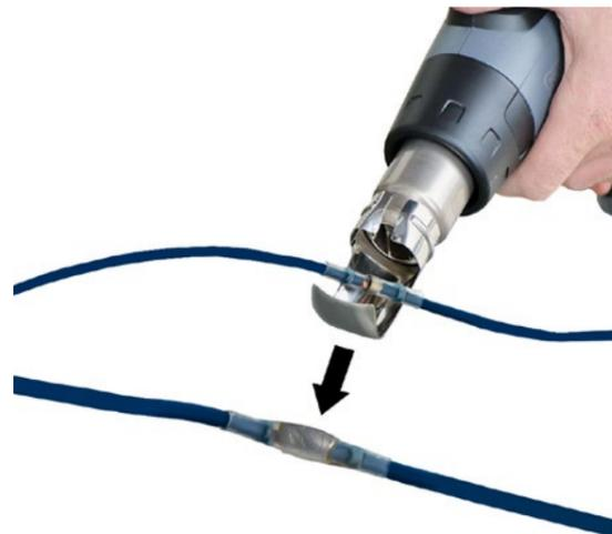
**3** Mit einem Heißluftfön mit Reflektordüse bei ca. 300-400 °C den Lötverbinder schmelzen. Außen beginnen, danach den Lötzinring zum schmelzen bringen. Das Lötzinn muss flüssig sein und die Kabelenden miteinander verbinden.
