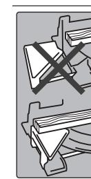
$\theta$  max. 216mm สังเกตขนาดของใบเลื่อย เส้นผ่าศูนย์กลางต้องเข้ากับแกนหมุนของเครื่องโดยไม่มีช่องคลวง อย่าใช้ช้อนลดหรือข้อบรรบ
