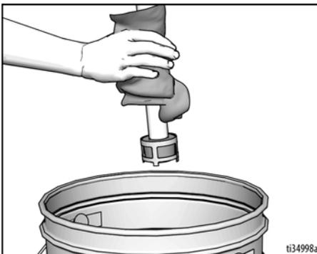
4. Das Saugrohr in geeignete Spülflüssigkeit legen. Das Ablassrohr in einen Abfalleimer legen.
