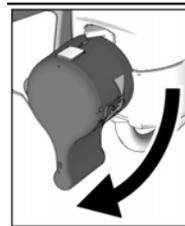
6. Den Druckregler auf „Prime/Slow“ (Entlüften/Langsam) und den EIN/AUS-Schalter auf **ON**-Position drehen, um den Motor zu starten. Spülflüssigkeit fließt durch das Saugrohr nach oben und aus dem Ablassrohr in den Abfalleimer. Die Spülflüssigkeit 5 Sekunden lang aus dem Ablassrohr fließen lassen.
