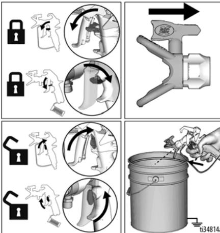
**HINWEIS:** Wenn sich die Spritzdüse schwer in die ENTSTOPFEN-Position drehen lässt, **Ablassen des Drucks**, Seite 18 durchführen, Entlüftungs-/Spritzventil horizontal auf SPRITZEN-Position stellen und Schritt 1 wiederholen.
