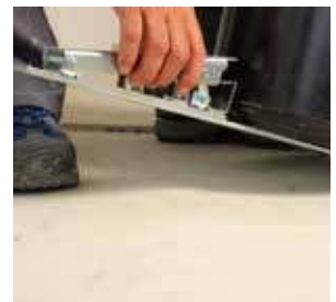
Die verstellbare Fußraste ermöglicht das Einspannen verschiedenster Eimerdurchmesser
