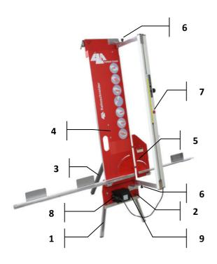
Zum Aufbau des Schneidegerätes nehmen Sie dieses aus der Verpackung und stellen es auf einen geeigneten festen Untergrund. Der Schneider kann an eine Wand gelehnt oder mit der beiliegenden Stütze als Standgerät betrieben werden. Dazu öffnen Sie an den Schiebefüßen (1) die Rändelknöpfe (2) und schieben sie bis Anschlag heraus und arretieren sie wieder. Dann verschrauben Sie die Stütze (3) in der gewünschten Neigung in der Gerüstklemme fest (4).
