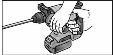
6. Bohrer ansetzen und Elektrowerkzeug einschalten.
