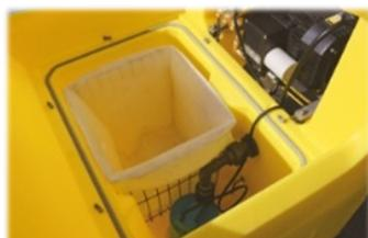
Filtersystem, Tauchpumpe und Hochdruckpumpe
