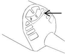
Drehzahlregler am hinteren Ende des Motors
