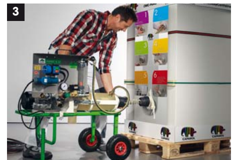
3 Ende der Trockenförderwelle am Durchlaufmischer fixieren
