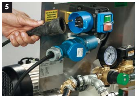
5 Wasser und Strom (230 V) anschließen
