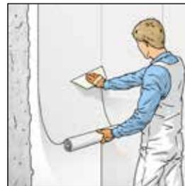
Den Wandbelag in das Klebebett einlegen und mit dem Tapezierschachtel so andrücken, dass sich der Kleber gleichmäßig verteilt und ein planer Untergrund entsteht.
