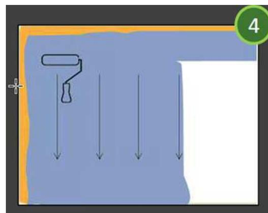
Nach dem Vorlegen der vier Bahnen wird die Fläche nur von oben nach unten abgerollt.
