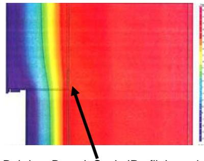
Bei dem Baumit SockelProfil therm ist aufgrund des geringen Wärmeverlustwertes keine Wärmebrücke mehr vorhanden.
