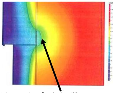
Bei normalen Sockelprofilen aus Aluminium ist eine große Wärmebrücke erkennbar, welche sich um das ganze Haus zieht!
