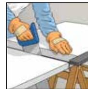
**3.** Innen-Dämmplatten mit einer Säge zuschneiden.
